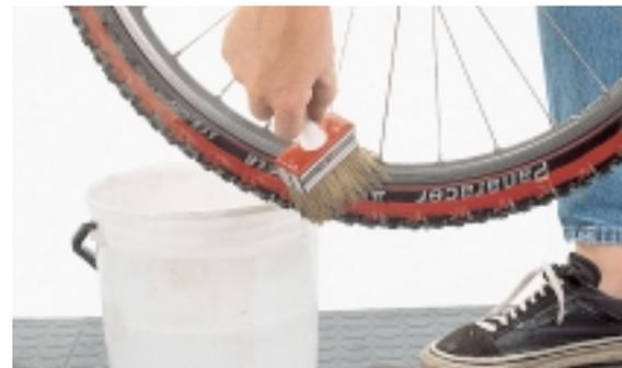
**2** Als nächstes sind die **LAUFRÄDER** dran. Von innen nach außen vorgehen – zuerst Naben und Speichen, dann Felgen und Reifen. Dabei werden die Reifenflanken gleich auf etwaige Beschädigungen wie Risse, Schnitte und Verschleiß untersucht.
