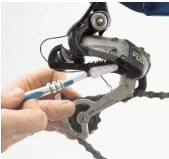
**4** In die letzten Winkel und Ritzen, zum Beispiel am **SCHALTWERK**, reicht der Pinsel nicht, wohl aber eine Zahnbürste. Sie kommt auch am Umwerfer, den Bremsen oder rund ums Hebelwerk von verwinkelten (Fully-)Hinterbau-Konstruktionen zum Einsatz.
