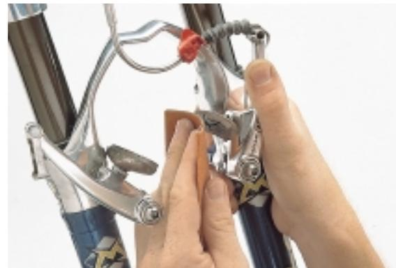
**5** Ja nicht vergessen: die **BREMSBELÄGE**. Mit feinem Schmirgelpapier die Bremsflächen von Unebenheiten und vor allem eingelagerten Schmutzpartikeln befreien, die sonst fiese Spuren auf den Felgenflanken hinterlassen würden.
